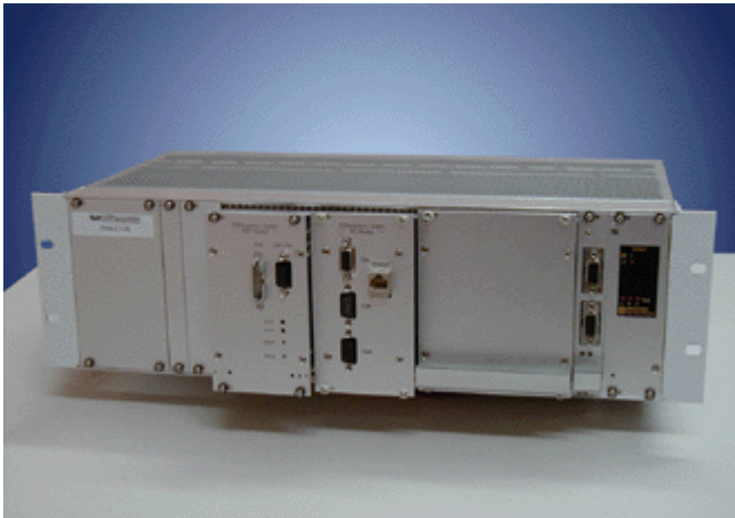
19"-Rack mit Festplatte, PC-Modul und DSP-Modul (von rechts nach links)
