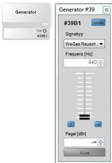
Der Funktionsblock „Generator“ beinhaltet einen Audio-Signalgenerator mit stellbarem Ausgangspegel.
