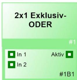
Der Funktionsblock „Exklusiv-ODER“ ist ein Logikgatter, das eine logische ausschließende Disjunktion implementiert. Wenn an genau einem der Eingänge ein „1/TRUE“ anliegt, wird am Ausgang auch „1/TRUE“ ausgegeben.
