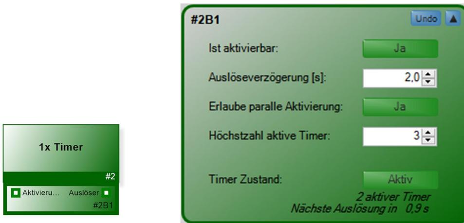
Der Funktionsblock „Timer“ ermöglicht, zeitverzögert zu einem Aktivierungssignal nachgelagerte Aktionen auszulösen. Nach Ablauf der Auslöseverzögerung gibt der Block einen True/False-Impuls am Logikausgang aus. Die Aktivierung des Timers kann sowohl über den Logikeingang des Blocks, als auch über den **<Timer Zustand>** erfolgen.
