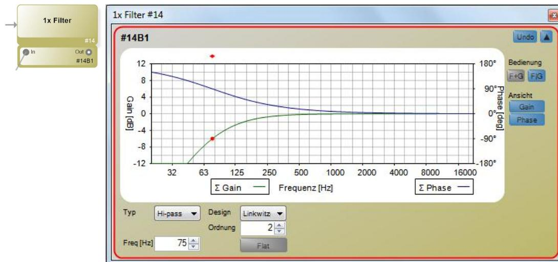
Der Funktionsblock „Filter“ stellt ein konfigurierbares Hochpass oder Tiefpass-Filter, und kann auch als Shelving-Filter arbeiten. Ein Block kann bis zu 64 Kanäle beinhalten und kann mehrere Kanäle in Gruppen verwalten.
