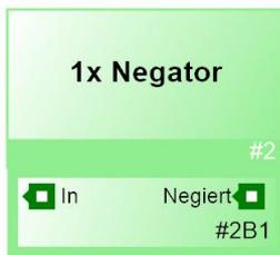
Der Funktionsblock „Negator“ kehrt den Zustand des am Eingang vorliegenden Logik-Steuersignals um und stellt den so negierten Logik-Zustand an seinem Ausgang bereit: „0/FALSE“ wird zu „1/TRUE“ und umgekehrt.
