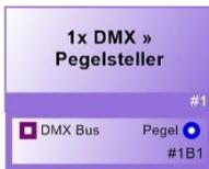
Der Funktionsblock „DMX » Pegelsteller“ realisiert die Umrechnung von DMX-Kanalwerten auf Pegelwerte. Er ermöglicht somit die Nutzung eines externen DMX-Controllers zur Steuerung von Audiopegeln im HARVEY. Dabei ist frei einstellbar, welcher Pegelbereich abgebildet werden soll.
