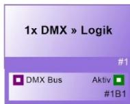
Der Funktionsblock „DMX » Logik“ schaltet einen Logikausgang, wenn ein DMX-Kanalwert einen bestimmten Schwellwert erreicht bzw. überschreitet auf „1/TRUE“ oder auf „0/FALSE“ bei Unterschreitung des Schwellwertes. Der Logikausgang kann mit anderen Blöcken verknüpft werden, zum Beispiel einem Pegelblock oder einem Preset-Block, um einen Pegel zu muten oder ein Preset zu rufen.
