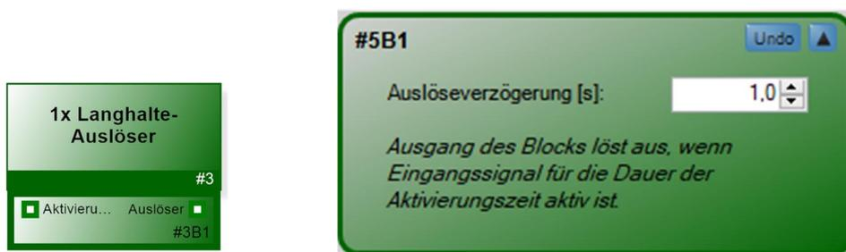
Der Funktionsblock „Langhalteauslöser“ ermöglicht die Auslösung eines Impulses am Logikausgang, nachdem ein Signal am Logik-Eingang lange genug auf „1/True“ gehalten wurde.
