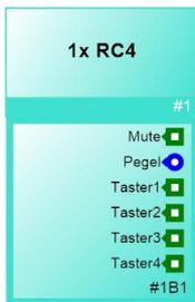
Der Funktionsblock „RC4“ repräsentiert ein PoE-versorgtes, netzwerkbasierendes HARVEY RC4 Bedienmodul.
