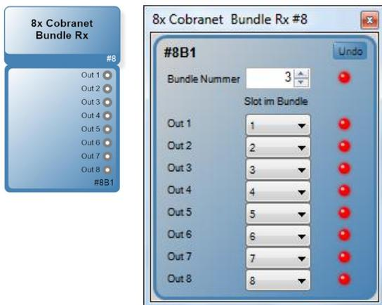
Der Funktionsblock „CobraNet Rx“ überträgt Audio-Signale von der CobraNet-Schnittstelle in die HARVEY mx.16 Software-DSP-Ebene. Ein „CobraNet Rx“-Funktionsblock empfängt dabei ein vollständiges CobraNet-Bundle mit 8 Audio-Kanälen (Slots) und stellt diese Audio-Signale zur weiteren Verarbeitung seinen Port-Ausgängen bereit. Die Slots eines CobraNet-Bundles können den Port-Ausgängen am Funktionsblock frei zugeordnet werden.
