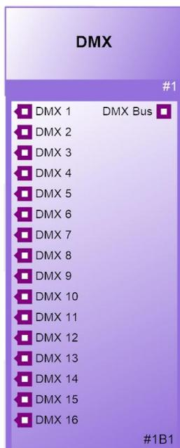
Der Funktionsblock „DMX“ reserviert und aktiviert die RS-485-Schnittstelle für einen Betrieb mit digitalen DMX-Steuersignalen. HARVEY kann dabei grundsätzlich als Sender (Master) oder Empfänger (Slave) auf dem DMX-Bus agieren.
