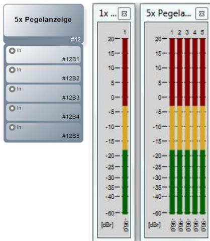
Der Funktionsblock „Pegelanzeige“ dient als Pegel-Messinstrument der optischen Signal-Kontrolle. Am Port eingehende Audio-Signale werden gemessen und im geöffneten Fenster der Block-Einstellungen visuell auf einer Skala in [dBr] (relativer Projekt-Bezugspegel) dargestellt. Der Block bietet keine Port-Ausgänge.
