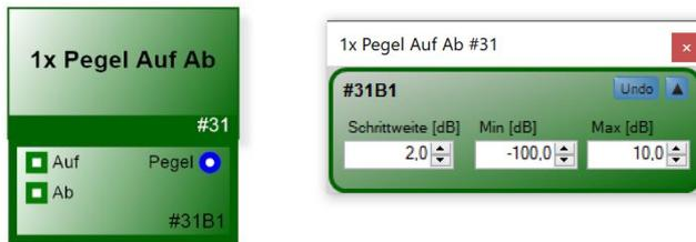
Der „Pegel Auf/Ab“-Block ermöglicht die schrittweise Änderung von Pegelstellern über binäre Steuereingänge. Eine Aktivierung am Logik-Eingang „Auf“ führt zu einer Erhöhung des angeschlossenen Pegels um die eingestellte Schrittweite. Aktivierung am Logik-Eingang „Ab“ führt zu einer Verringerung des Pegels um die Schrittweite.
