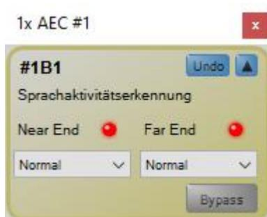
Die „LED“-Anzeigen im Parameterdialog dienen als Indikator, ob ein lokaler (**[Near End]**) oder entfernter (**[Far End]**) Sprecher erkannt wurde. Abhängig davon erfolgt eine zusätzliche Dämpfung des Ausgangspegels.
