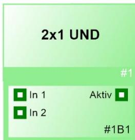
Der Funktionsblock „UND“ ist ein Logikgatter, das eine logische Konjunktion implementiert. Wenn an allen Eingängen ein „1/TRUE“ anliegt, wird am Ausgang auch „1/TRUE“ ausgegeben.
