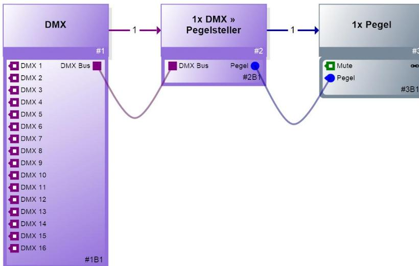
Hinweis: Analog zu den Pegelstellern in HARVEY Composer erfolgt eine Wichtung der Pegelskala, so dass Werte um 0 dB mit höherer Genauigkeit einstellbar sind. Normale lineare Hardware-DMX-Schieberegler erhalten durch diese Adaption das Stellverhalten, wie man es von Audio-Mischpulten kennt.
