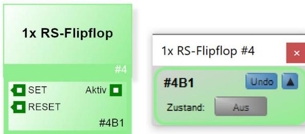
Der Funktionsblock „RS-Flipflop“ ist eine bistabile RS-Flipflop-Kippstufe. Eine vorübergehend am SET-Eingang anliegende „1/TRUE“ führt zum dauerhaften Ausgangszustand „1/TRUE“. Eine vorübergehend am RESET-Eingang anliegende „1/TRUE“ setzt den Ausgangszustand auf „0/FALSE“ zurück. Liegen an beiden Eingängen zeitgleiche „1/TRUE“-Zustände an, wird der Ausgangszustand per Zufall gesetzt.
