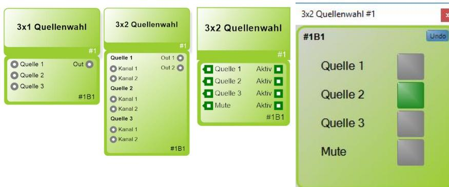
Der Funktionsblock „Quellenwahl“ bietet dem Nutzer die Auswahl einer von mehreren Audioquellen. Die gewählte Quelle wird auf den Ausgang gelegt. Je Quelle können ein oder mehr Audiokanäle konfiguriert werden, welche bei Wahl einer Quelle gemeinsam umschalten. Der Wechsel zwischen zwei Quellen wird über Crossfading sanft realisiert, so dass es nicht zu Knacksen beim Umschalten der Quelle kommt.
