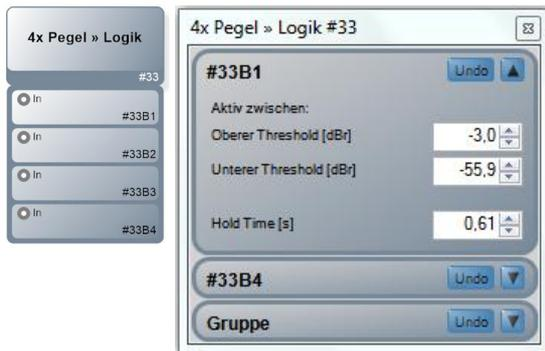
Der Funktionsblock „Pegel » Logik“ bewertet am Port eingehende Audio-Signale und schaltet zu definierten Bedingungen (abhängig vom gemessenen Audio-Pegelwert) seinen Logik-Ausgang aktiv (1) oder inaktiv (0). Dieser Funktionsblock hat lediglich einen Port-Eingang in der Audioebene und einen Logik-Port-Ausgang in der Steuerungs-Ebene. Der Block kann mehrere Kanäle in einem Funktionsblock verwalten.
