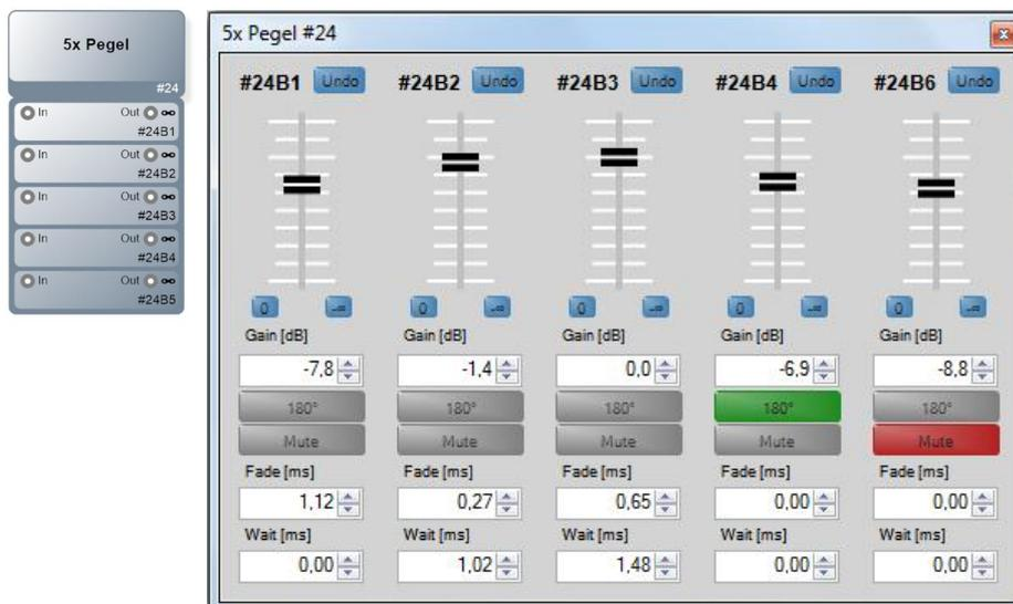
Der Funktionsblock „Pegel“ stellt Pegelanpassung, Polaritätstausch und Mute von Audio-Signalen für bis zu 64 Kanäle. Der Block bietet keine Kanal-Summierung, jeder Kanal hat seinen eigenen Port-Ausgang.
