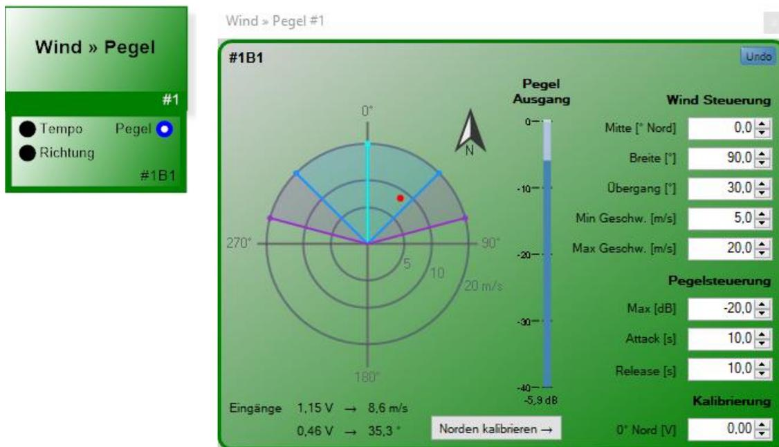
Der Funktionsblock „Wind » Pegel“ ermöglicht eine Pegel-Steuerung über ein an die HARVEY-Spannungseingänge angeschlossenes Windmessgerät (Anemometer). Letzteres liefert Information zu Windrichtung und Windgeschwindigkeit.
