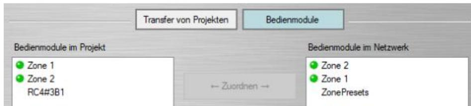
Hinweis: An den gepaarten Bedienmodulen verschwindet erst nach erfolgreicher Verbindung zum HARVEY-Gerät die bau blinkende Status-Signalisierung. Stattdessen zeigen die LEDs den aus dem HARVEY-Projekt zugewiesenen Zustand. Voraussetzung hierfür ist, dass das Projekt auf dem HARVEY-Gerät läuft.
