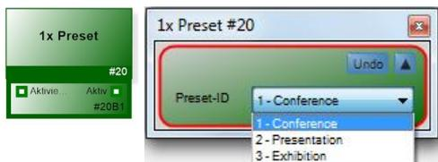
Der Funktionsblock „Preset“ stellt beim Zustand „1/TRUE“ an seinem Steuer-Logik-Eingang ein im Projekt definiertes Preset ein. Mit diesem Block können gespeicherte Parametersätze abgerufen werden. Er verfügt über einen Steuer-Logik-Ausgang, welcher aktiv ist, wenn das im Block eingestellte Preset aktiv ist. Diese Zustandsanzeige erfasst auch, wenn das gewählte Preset über einen anderen Mechanismus (z.B. H-Text) gerufen wird.
