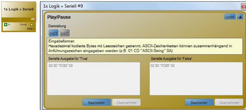
Der Funktionsblock „Logik » Seriell“ wertet den Zustand an seinem Steuer-Logik-Eingang aus, und löst in Abhängigkeit dessen ein definiertes serielles Datenpaket für „True“ und/oder „False“ einmalig aus. Er verfügt in der Steuerebene über einen seriellen TX-Ausgang, um die ausgelösten Datenpakete an eine Serielle Schnittstelle zu übertragen.
