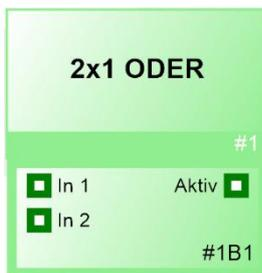
Der Funktionsblock „ODER“ ist ein Logikgatter, das eine logische Disjunktion implementiert. Wenn an einem der Eingänge ein „1/TRUE“ anliegt, wird am Ausgang auch „1/TRUE“ ausgegeben.
