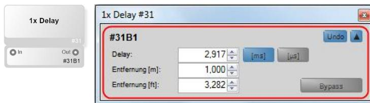
Der Funktionsblock „Delay“ gibt das Audio-Eingangssignal um Samples verzögert wieder aus, und eignet sich besonders um Schall-Laufzeiten von verschiedenen Schallquellen anzugleichen. Gestellt wird die Verzögerung nicht in Sample-Einheiten, sondern entweder über die gewünschte Zeit-Verzögerung oder Laufzeit-Verzögerung.
