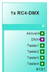
Der Funktionsblock "RC4-DMX" stellt eine PoE-betriebene, netzwerkbasierte HARVEY RC4-Fernbedienung für DMX-Lichtsteuerungsanwendungen dar.
