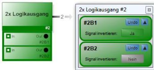
Der Funktionsblock „Logikausgang“ überträgt Logik-Signalzustände aus der Software-Ebene an die hardwareseitigen Logikausgänge „Relay Outputs 2-4“ des HARVEY mx.16 bzw. „Control Digital Out 1-4“ und „Control Relay 1-2“ des HARVEY Pro.
