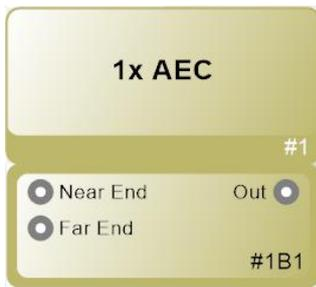
Der Funktionsblock „AEC“ („Acoustic Echo Cancellation“) realisiert eine Unterdrückung akustischen Echos, welches entsteht, wenn ein Mikrofon die Ausgaben eines lokalen Lautsprechers ungewollt wieder aufnimmt.
