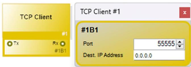
Der Funktionsblock „TCP Client“ erlaubt es, den HARVEY-Geräten externe Geräte über ein Ethernet-Netzwerk zu steuern, welche hierzu einen TCP-Port bereitstellen. Ein beispielhafter Anwendungsfall ist die Steuerung eines Videoprojektors.
