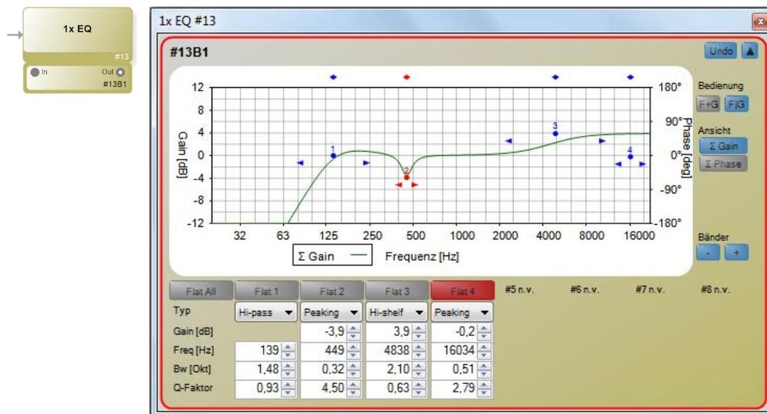
Der Funktionsblock „EQ 1..8“ bietet bis zu 8 unabhängige, vollparametrische Filter pro Kanal. Ein Block kann bis zu 64 Kanäle beinhalten und kann Kanäle in Gruppen verwalten.
