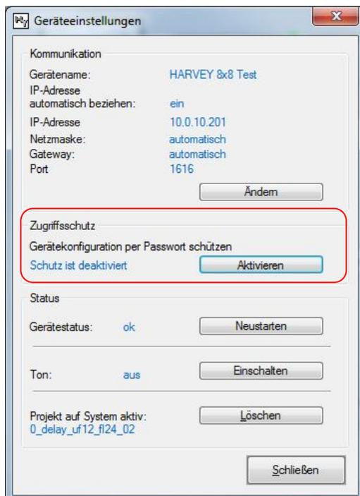
Unter dem Eintrag „Zugriffsschutz“ meldet das Gerät den Zustand des Zugriffsschutzes entweder mit der Ausgabe „Schutz ist deaktiviert“ oder „Schutz ist aktiviert“.
