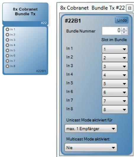
Der Funktionsblock „CobraNet Tx“ überträgt Audio-Signale aus der HARVEY mx.16 Software-DSP-Ebene in ein CobraNet-Netzwerk. Ein „CobraNet Tx“-Funktionsblock stellt 8 Port-Eingänge bereit und sendet die Audio-Signale als vollständiges CobraNet-Bundle mit 8 Slots (Audio-Kanälen) an die CobraNet-Schnittstelle. Die 8 Port-Eingänge können den 8 Slots im Funktionsblock frei zugeordnet werden.
