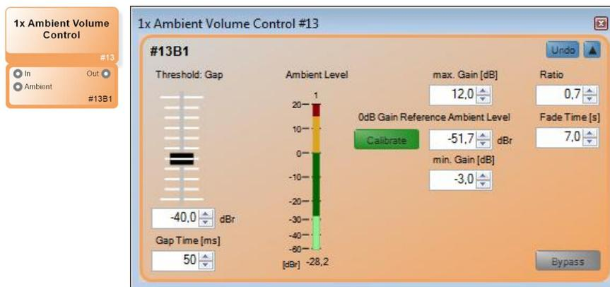
Der Funktionsblock „AVC“ (Ambient Volume Control) ist ein Werkzeug zur automatischen Anpassung der Programmlautstärke (z.B. Lautstärke einer Durchsage) in Abhängigkeit von der Umgebungslautstärke.
