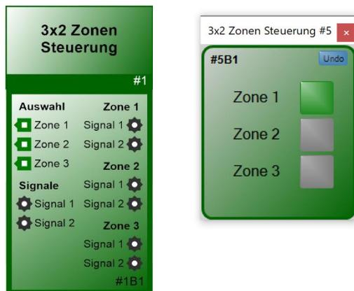
Der Block „Zonen-Steuerung“ leitet Steuersignale abhängig von der Zonenauswahl in eine von mehreren Zonen weiter. In den Block-Eigenschaften ist die Zahl der Signale und Zonen einstellbar.
