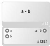
Der Funktionsblock „a – b“ bildet das Differenzsignal der beiden Audio-Signale an den Eingängen „a“ und „b“, und stellt es als Audio-Ausgangssignal bereit. Mit dem Block kann aus den Seiten eines Stereo-Tonsignals (L/R) das Differenz bzw. „Seiten“-Signal gebildet werden. Ein solches Differenzsignal dient häufig als Grundlage für Pseudo-Surround-Kanäle.
