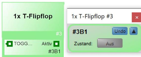
Der Funktionsblock „T-Flipflop“ ist ein Toggle-Flipflop. Eine Aktivierung am Toggle-Eingang führt zu einem Zustandswechsel am Ausgang.
