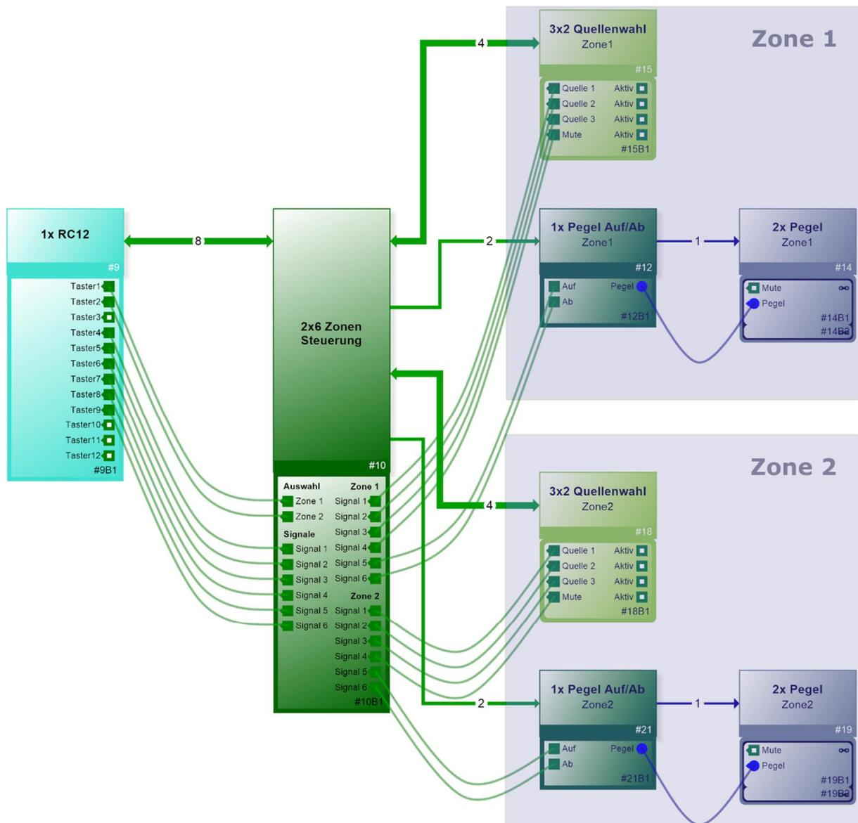
Die Abbildung zeigt beispielhaft die Integration des Blocks „Zonen-Steuerung“ in einem Projekt mit zwei Zonen. Die angeschlossene RC12 gewinnt damit folgende Funktionalität:
