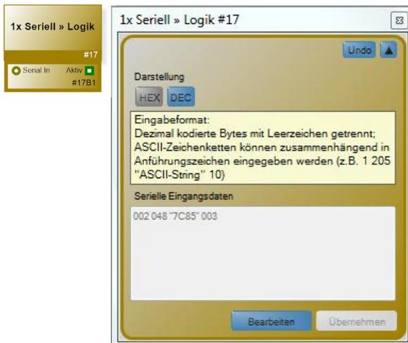
Der Funktionsblock „Seriell » Logik“ stellt bei Empfang eines bestimmten seriellen Datenpaketes seinen Steuer-Logik-Ausgang kurzzeitig auf „1/TRUE“. Ein dauerhafter Zustand kann in Kombination mit einem nachgeschalteten „RS-Flipflop“ erreicht werden. Der Block verfügt in der Steuerebene über einen seriellen RX-Eingang, über den die seriellen Datenpakete empfangen werden.
